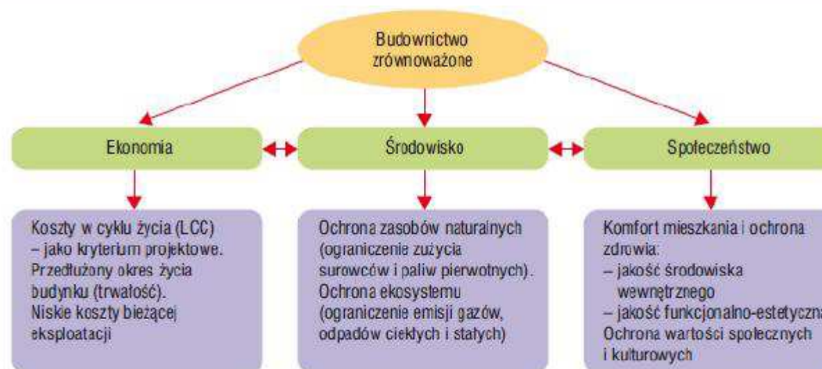
Rys. 2. Elementy i parametry budownictwa zrównoważonego
