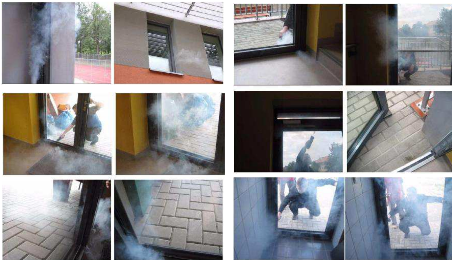
Nieszczelności na uszczelkach między skrzydłem a ramą stolarki okiennej i drzwiowej
