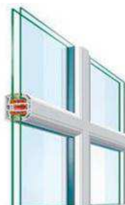
Rysunek J.3 – Wiele szprosów wewnętrznych w IGU ze szprosami nakładanymi lub bez nich
