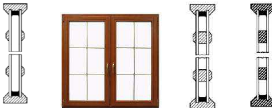
Rysunek J.1 – Szpros (szpros) nakładany (nakładane)
