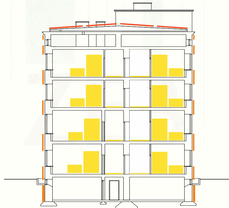
zewnętrzna izolacja termiczna panele fotowoltaiczne nowe wnętrza
