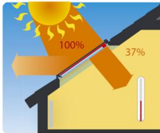
Okno z roletą wewnętrzną zaciemniającą
