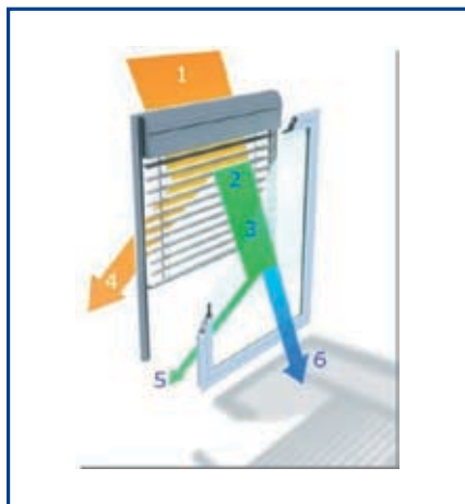
Schemat działania żaluzji listewkowych zewnętrznych (z materiałów SELT)
